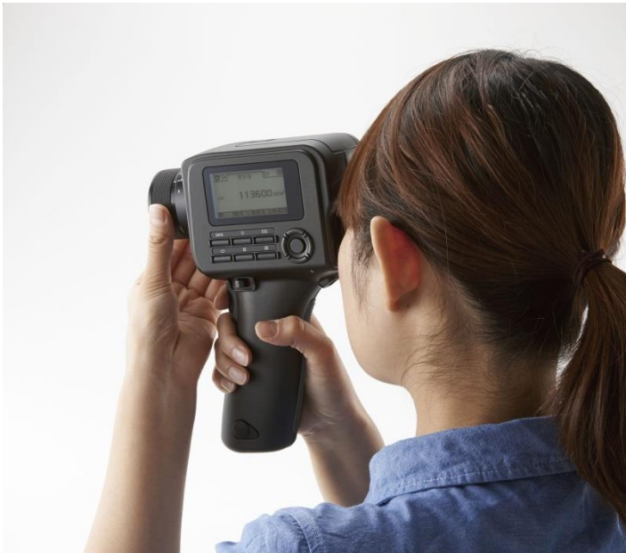
Luminance-mètre Mesure une luminance (candela par mètre carré = \text{cd}/\text{m}^2 ) (prix > 4000€)
