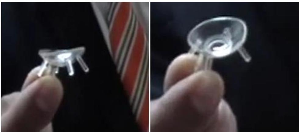
**Figura 33. Electrodo tipo lente de contacto**
