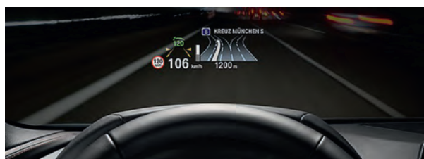
Figure 9 : Système tête haute « HUD » de BMW.
